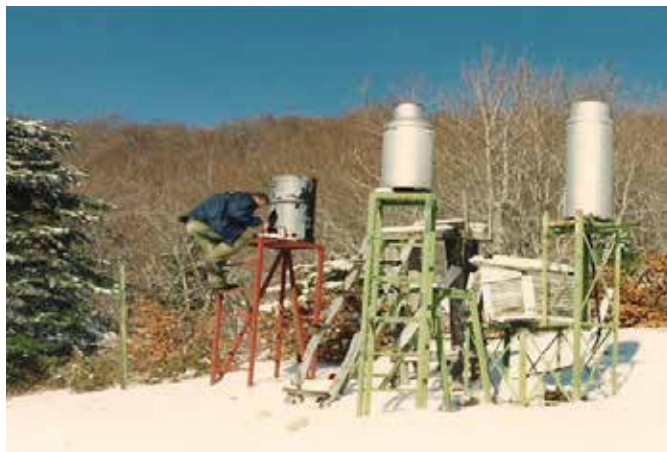
Χιονοβροχογράφοι 750 και 300 mm, αντίστοιχα, και χιονοβροχομέτρο ύψους και διαμέτρου 1000 και 400 mm, αντίστοιχα, H= 1120 m
