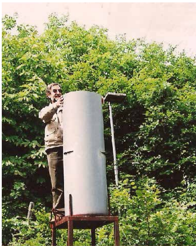
Ογκομετρικό βροχόμετρο ύψους και διαμέτρου 1300 και 440 mm, αντίστοιχα, για ταμίευση των μέγα-επεισοδίων βροχής.
